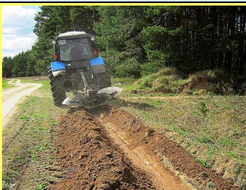
Рекомендуется создавать полосы шириной не менее 2,0-2,5 м. наиболее подходящим для выполнения данной работы является плуг лесопожарный комбинированный ПЛК-2,0, создающий минерализованную полосу шириной 2,3 м.
